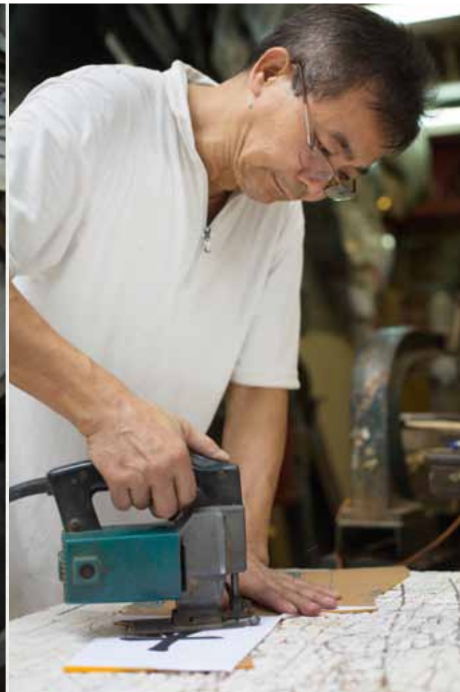
老闆胡廣祥把寫／印好的字鋪在發泡膠板上以線鋸切割
